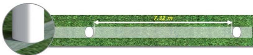
Si les poteaux sont elliptiques (coupe transversale), l'axe le plus long doit être perpendiculaire à la ligne de but. De même, l'axe le plus long de la barre transversale doit être parallèle au plan du terrain.
